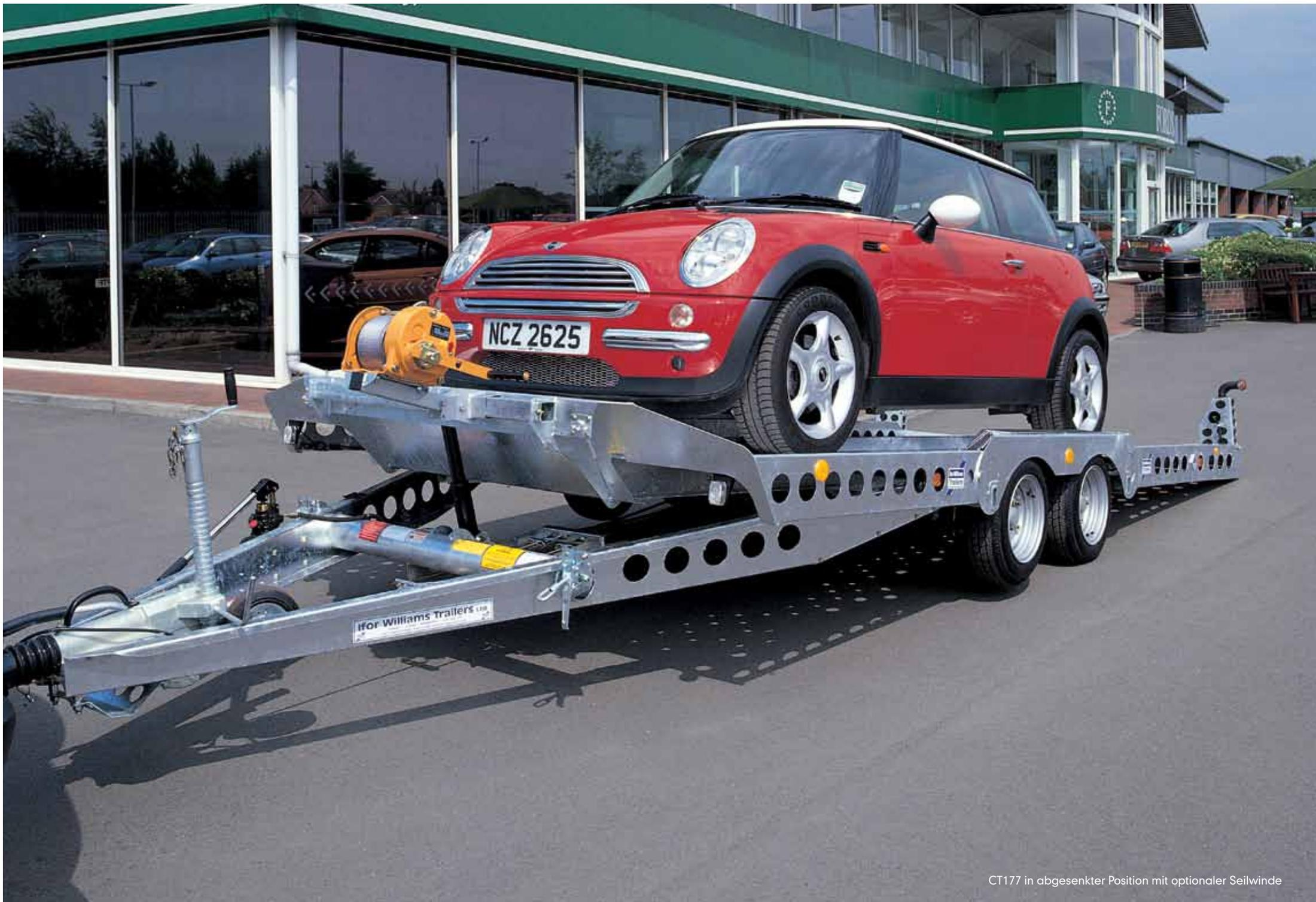
CT177 in abgelenkter Position mit optionaler Seilwinde
