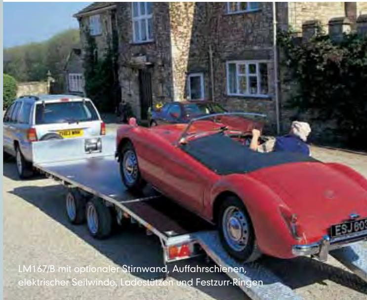
LM167/B mit optionaler Stirnwand, Auffahrschienen, elektrischer Seilwinde, Ladestützen und Festzurr-Ringen
