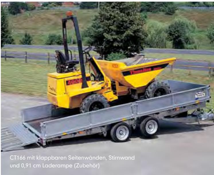
CT166 mit klappbaren Seitenwänden, Stirnwand und 0,91 m Laderampe (Zubehör)
