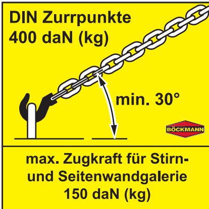
Abb. 6: Aufkleber Angaben zu Zurrpunkten am Anhänger
