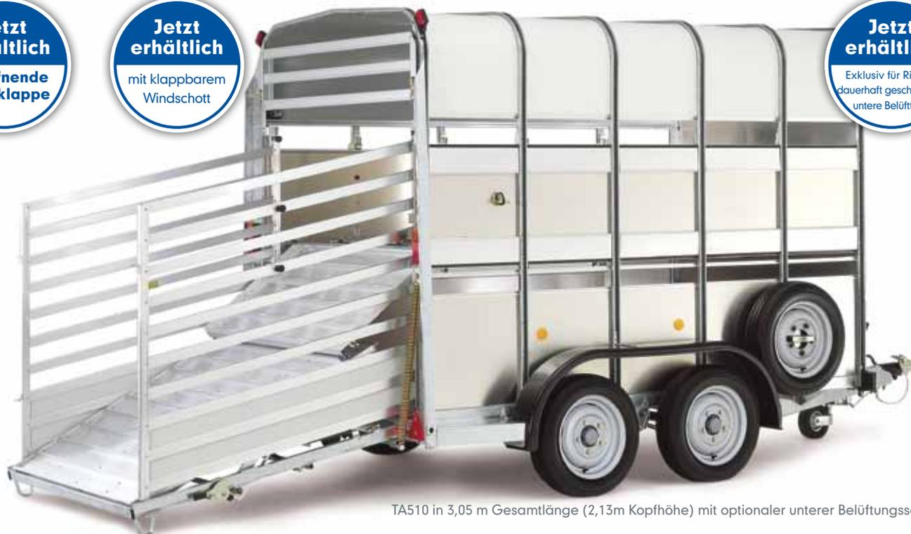
TA510 in 3,05 m Gesamtlänge (2,13m Kopfhöhe) mit optionaler unterer Belüftungsschiene
