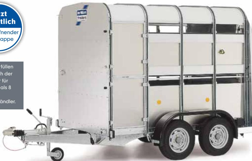
TA5 2,44 m Länge (1,83 m Kopfhöhe) optional mit unterer Lüftungsschiene
