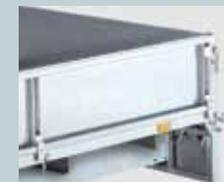
Optional: Halterungen für klappbare Seitenwände und ein Seitenwand-Kit
