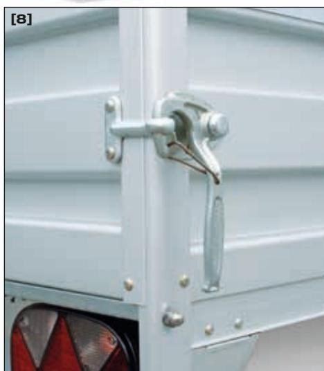
**Sicher verladen:** Mit den großen, massiven Winkelhebelverschlüssen ist ein schnelles Be- und Entladen möglich.
