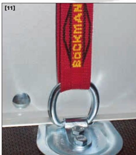
**Sicher unterwegs:** Die Verzurrösen sind fest mit der Siebdruckbodenplatte verschraubt und ermöglichen eine optimale Sicherung der Ladung.
