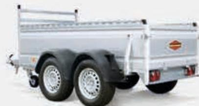
**Mehr Platz:** Mit der Bordwanderhöhung auf 560 mm (bis 1160 mm möglich) erhöhen Sie das Ladevolumen.
