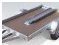
Befestigung der Auffahrschienen auf der Siebdruckbodenplatte.
