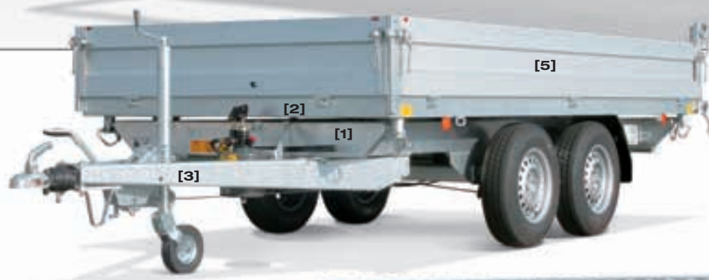
Groß. Größer. DK-AL 3718: Mit dem größten Kippermodell komplettiert Böckmann sein Dreiseitenkipper-Programm (Abmessungen: 3740 x 1800 x 350 mm).
