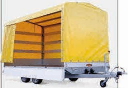
**Praktisch:** Die optional zur Plane- und Spriegelkonstruktion erhältliche seitliche Schiebeplane ist ideal für eine schnelle und komfortable Beladung von der Seite.
