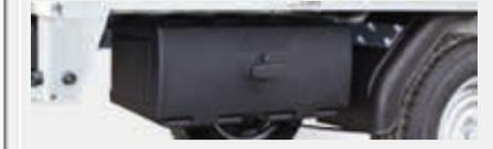
**Stauraum für wichtige Utensilien:** Der abschließbare Staukasten ist mit 440 x 150 x 210 mm und einer max. Beladung von 20 kg sehr geräumig.
