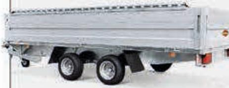
**Mehr Platz:** Die Bordwanderhöhung erhöht die Bordwände von 300/350 auf 500 mm – für massig Zuladung.
