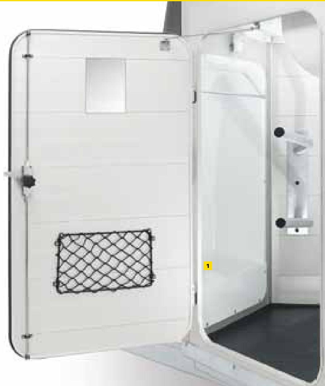
Neue Türen aus dem Caravanbereich für mehr Schließkomfort und Stabilität.
